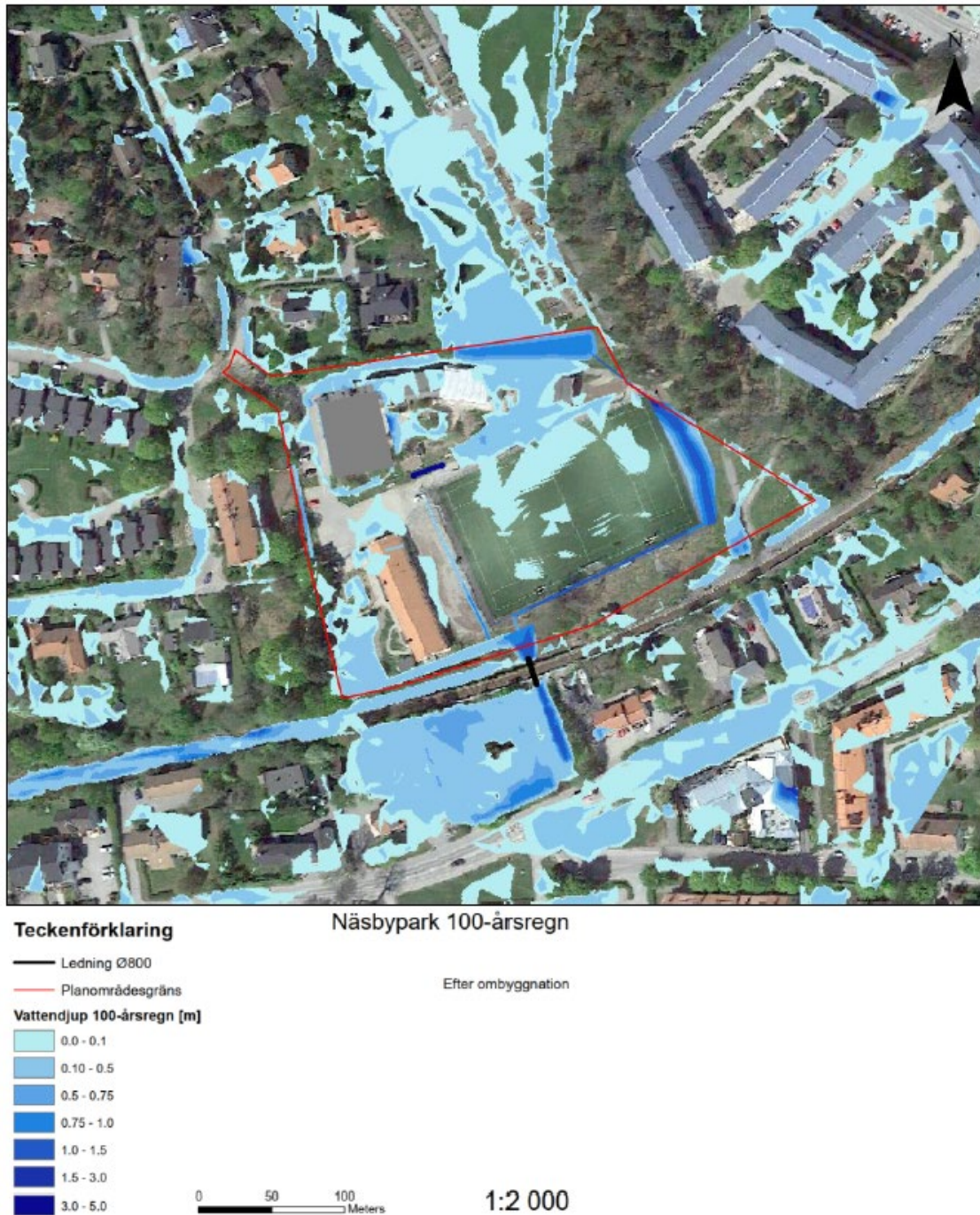
Figur 22: Skyfallsmodellering med föreslagna lösningar. Vatten leds bort från byggnaden mot parkområden samt parkering och grönytor (Dagvattenutredning Näsbypark 73:40 m.fl., Niras).
