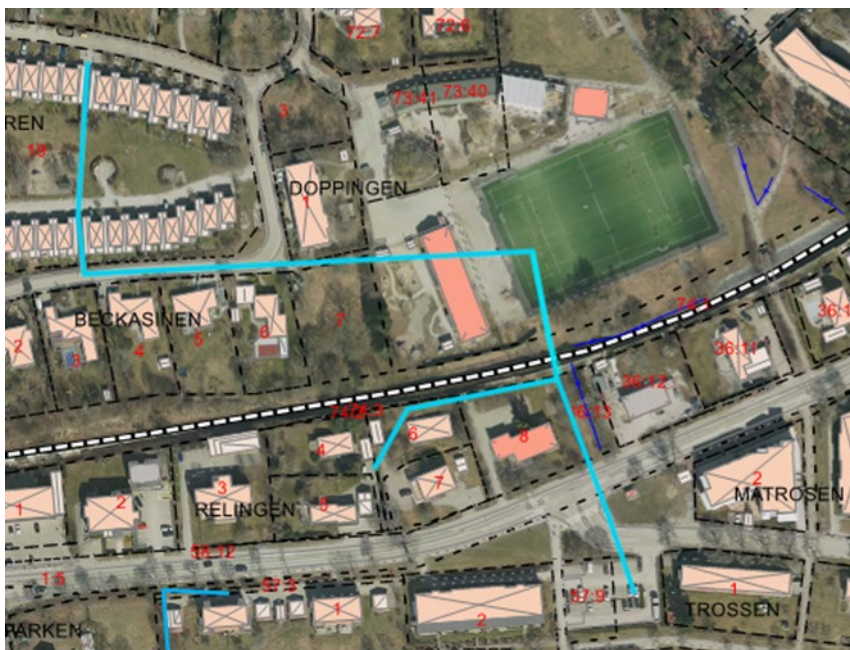
Figur 11: Spillvattenledningar i behov av uppdimensionering.
